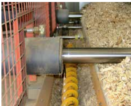
Ett hydraulikaggregat och en hydraulisk cylinder driver skraporna.
