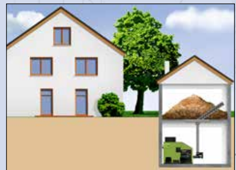
Exempel: Siloutmatning ur spånsilo med lutande skruv
