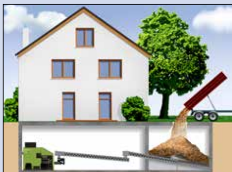
Exempel: Transport av bränsle från ett avlägset lagringsutrymme via en andra transportskruv
