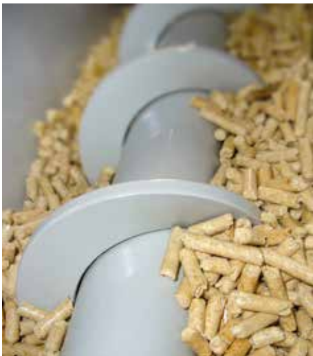
HDG:s pellets-utmatningsskruv transporterar pellets ur rektangulära lagringsutrymmen
