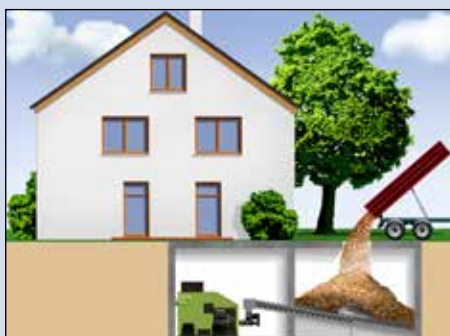
Exempel: Underjordiskt lagringsutrymme med körbart tak
