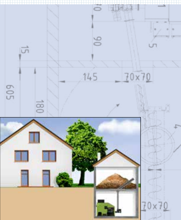
Exempel: Siloutmatning ur spånsilo med lutande skruv
