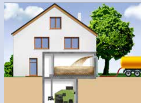
Exempel: Lagringsutrymme för pellets med inblåsningsanordning
